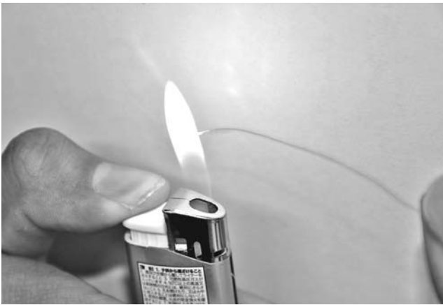
図2 ワイヤー電極のコーティングを取る作業
