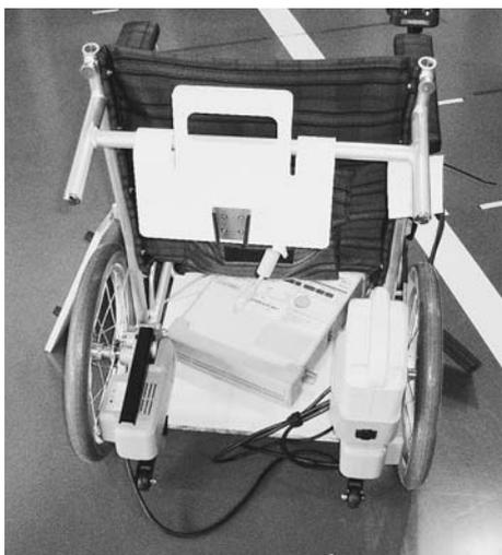
図2 電動車椅子の座面下の呼吸器搭載スペース
